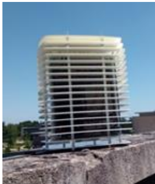
Figure IV.32 Première micro-station environnementale QameleO : le boîtier PVC est ici entouré d'ailettes blanches. Photo © N. Martiny.
