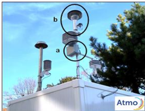
Figure IV.26. L'un des premiers micro-captteurs UB/IRD installé sur la station de mesures de Péjoces d'ATMO-BFC en 2018. Le micro-captteur est indiqué par la lettre a. La tête PM de l'analyseur de référence est indiquée par la lettre b. Figure extraite du stage de M2 de Lola Canovas (2019) , Partie B/§4.7.
